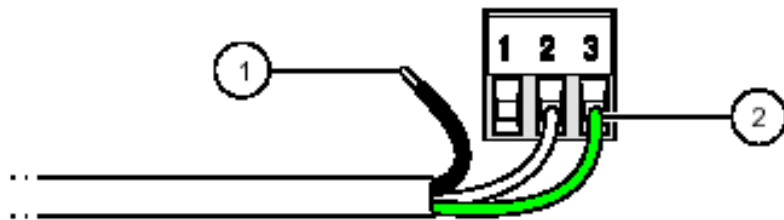
图 14 正确的导线准备及插入
